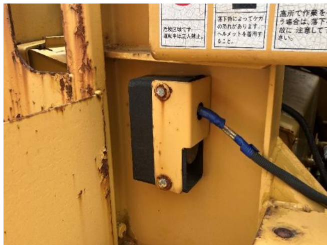
走行アラーム劣化(音声小さい)
