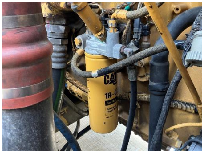
燃料エレメント 交換
