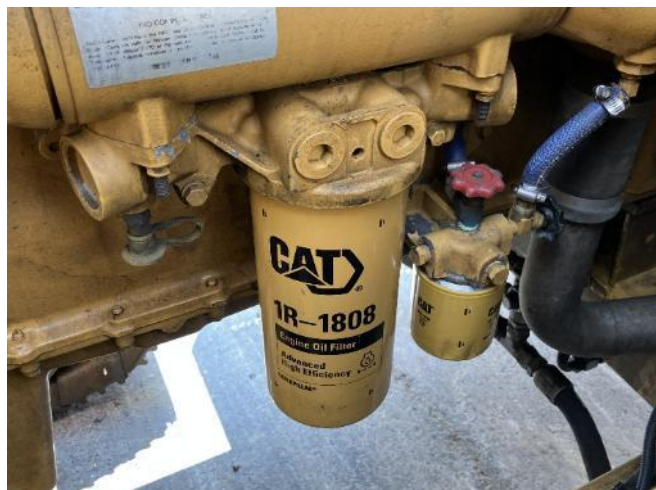
エンジンオイル/エレメント 交換
