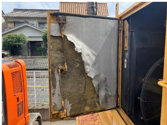
エンジンフード防音材 劣化
