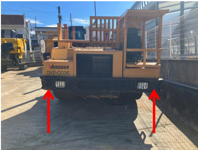
ウィンカー左右とも欠損
